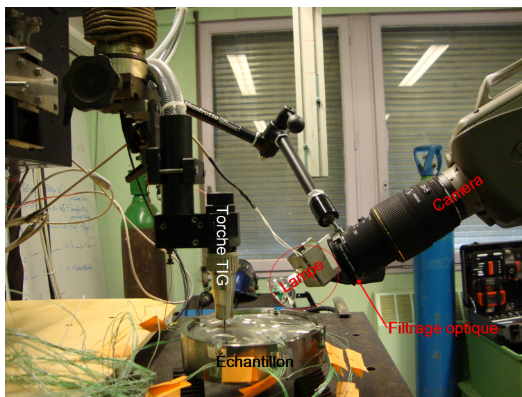
Figure 4.10 – Positionnement de la caméra
